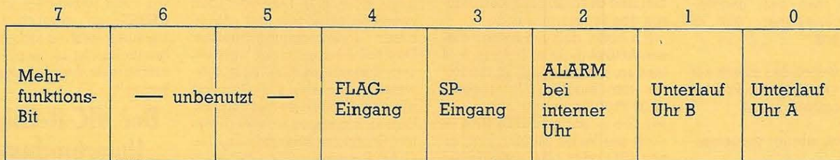
Bild 5. Genereller Aufbau der Unterbrechungs-Kontroll-Register (13) der beiden CIA-Bausteine
